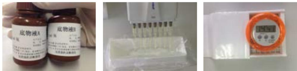
8·待到达显色时间后，每微孔中加入 100 μL 终止液，并在 5min 内读取数据，酶标仪采用单波长检测 (650nm)，读数软件读取的 OD 值直接打印计算结果。
