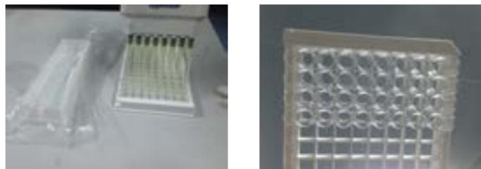
7·尽快将底物 A 液和底物 B 液等量混合，混匀后每孔加入 100 μL，盖上盖板膜，室温 (25±2℃) 下，避光反应 15 min（注：底物工作液也可提前配制，但配制完后需 5min 内使用）；
