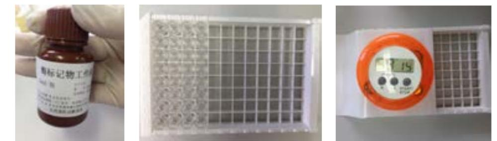
6·待反应时间完成，重复第4步操作，甩掉孔中的溶液，每孔加入稀释好的洗涤液 300 μL，震荡洗涤4次，每次 30s 左右，在干净吸水纸上拍打去除残存洗涤液（孔内无气泡）；
