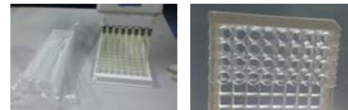
5 · 每孔加入 100  $\mu$ L 酶标记物工作液, 盖好盖板膜, 轻轻振荡酶标板 10 s, 充分混匀, 室温下 ( $25 \pm 2^\circ\text{C}$ ) 避光反应 60 min;
