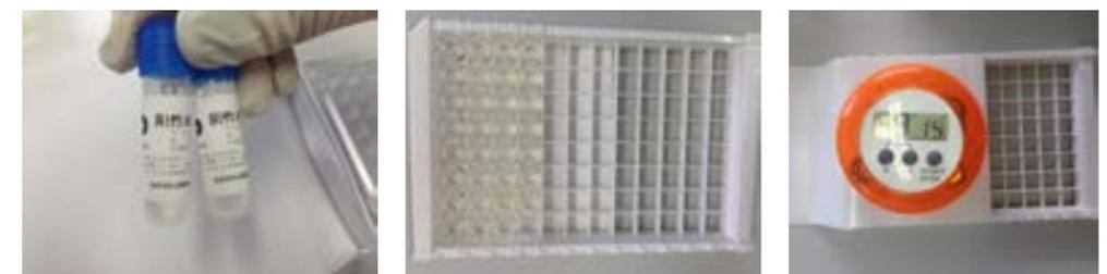
4 · 待反应完成, 甩掉孔中的溶液, 每孔加入稀释好的洗涤液 300  $\mu$ L, 震荡洗涤 4 次, 每次 30s 左右, 在干净吸水纸上拍打去除残存洗涤液 (孔内无气泡);
